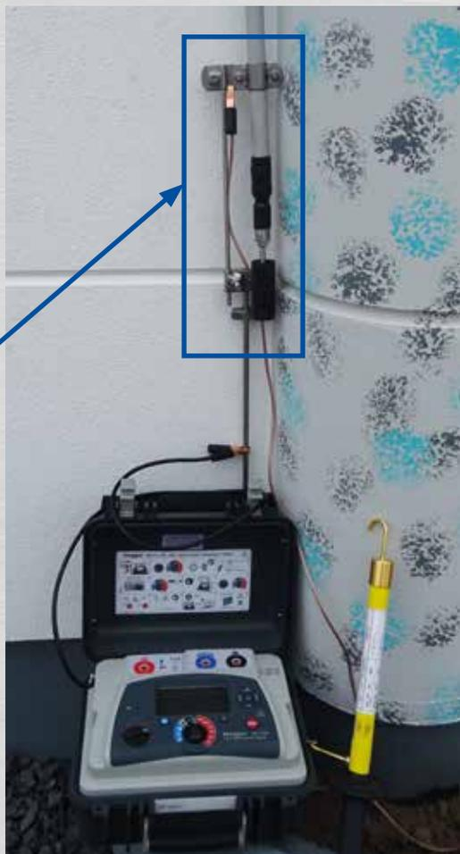
Equipo de prueba necesario para el ensayo de aislamiento:
