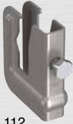
Apta para el uso de conductores redondos de  $\varnothing$  10 mm como separadores para la colocación de puestas a tierra de cimentaciones en platinas de 30 x 3,5 mm de canto o redondos de  $\varnothing$  10 mm.
