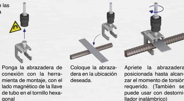
Ponga la abrazadera de conexión con la herramienta de montaje, con el lado magnético de la llave de tubo en el tornillo hexagonal
