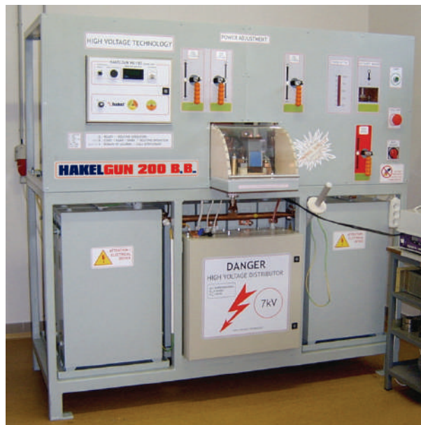
Generador de corriente de rayo con capacidad de servicio I_{imp} = 210kA (10/350).
